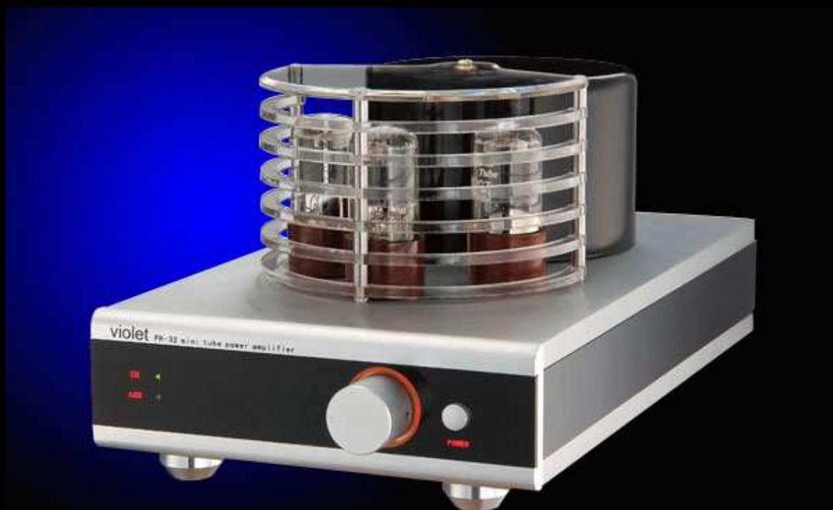
感謝您購買本站 PH32 真空管/FET HYBRID 綜合擴大機。PH32 一款真空管與 FET 混血設計的擴大機，兼具真空管溫暖鮮明的音色與 FET 的強大輸出功率與細緻質感。信號放大採用三支 6SN7 真空管，功率放大採用 MOSFET，八歐姆可輸出 50W，最大可達 100W 足功率輸出，推力足，控制力佳，完全沒有純管機低頻受限的困擾。可接受兩組訊源輸入，配合電子切換的設計，好聽又實用。其餘保護線路與開關機延遲都相當完備，是非常完善的設計。
